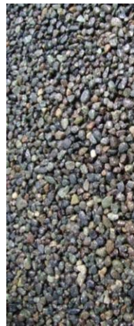
新技術：珪砂混合型自然石樹脂舗装
