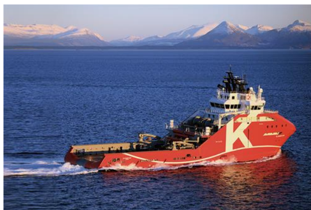
図 2.4.3 アンカーハンドリング・タグサプライ船 (出典：日本埋立浚渫協会)
