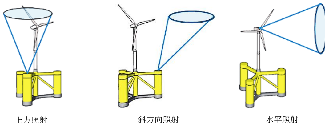
図 2.3.6 洋上風力発電施設からの風況計測 (出典：石田茂資、二村正、2016)
