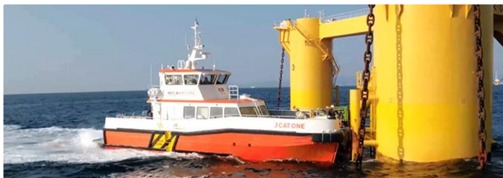
図 3.3.25 福島復興・浮体式洋上ウィンドファーム実証研究事業の通船 (出典：東京汽船ウェブサイト)
