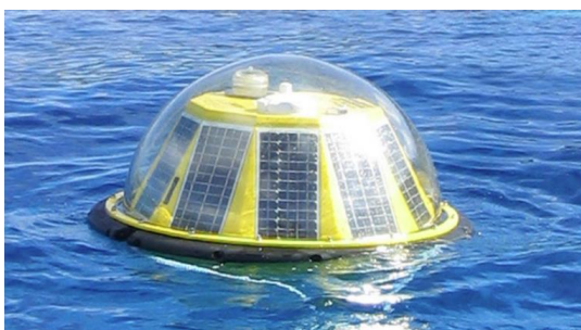
図 2.3.8 ブイ式加速度式波浪計の例 (出典：AXYS Technologies 社ウェブサイト)
