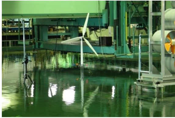
図 3.3.11 水槽模型試験の様子（ロータ直径：165cm） （出典：海上・港湾・航空技術研究所海上技術安全研究所提供）
