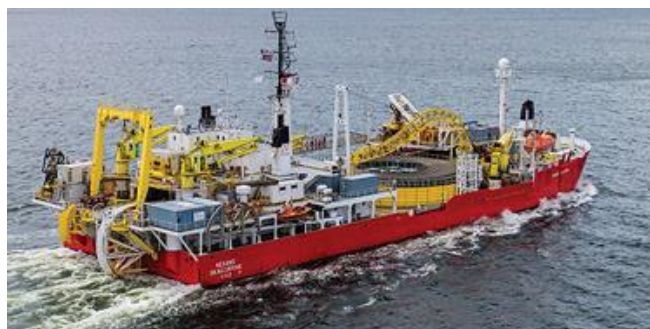
図 3.2.29 海底ケーブル敷設船 (出典：日本財団ウェブサイト)
