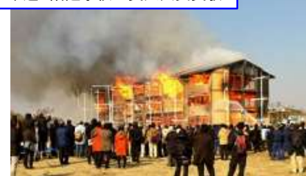
木造3階建て学校の実大火災実験
