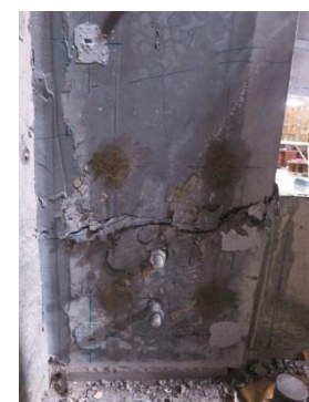
補強パネルひび割れ状況 (1/33rad.終了後、裏面)
