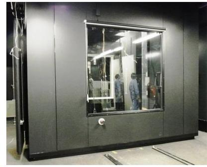
日射熱取得率測定装置の概観 (於 建築研究所)
