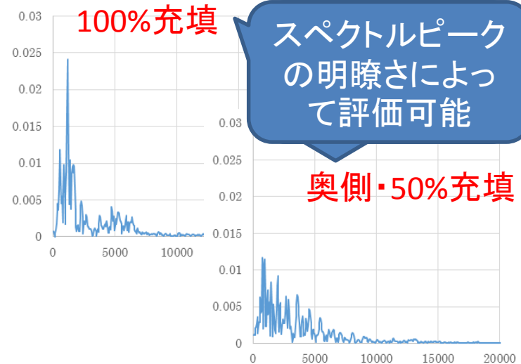
打音によるスペクトルの比較 38
