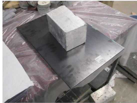
3. 広げた接着剤に重石をのせ硬化させる
