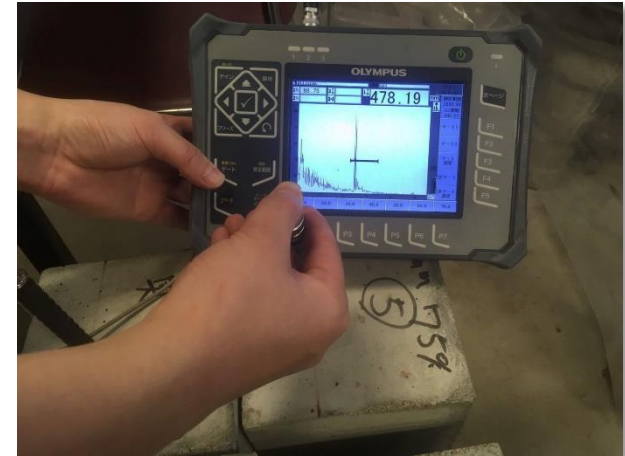
パルス反射法による測定状況
