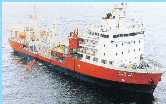
大型浚渫兼油回収船「海翔丸」
