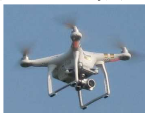
UAV(ドローン等)による3次元測量
