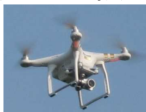
UAV(ドローン等)による3次元測量
