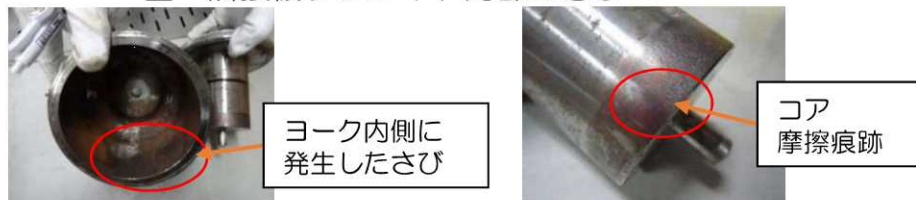
図 隣接機ソレノイド内部のさび
