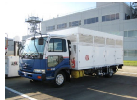
電源車(移動式インバータ)1台配備
