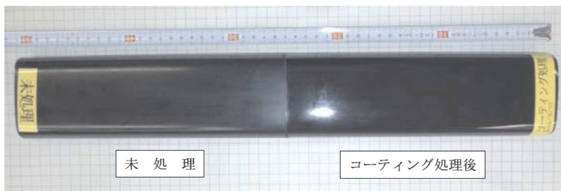
図 1-2 本件同等のハンドレール「Dポ」へのコーティング加工前後の外観
