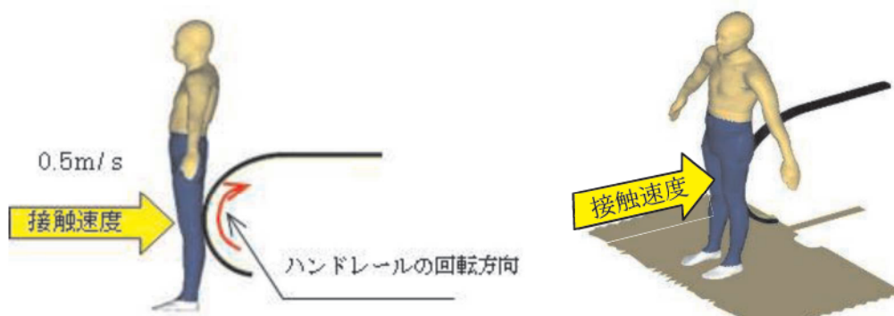
図 14 ハンドレールへの接触により人体が持ち上がる可能性を検証するモデル
