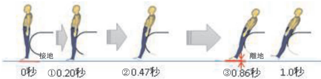
図 19 長身体型モデル、他種ニュアル形状（摩擦係数 1.08）の条件における持ち上がり
