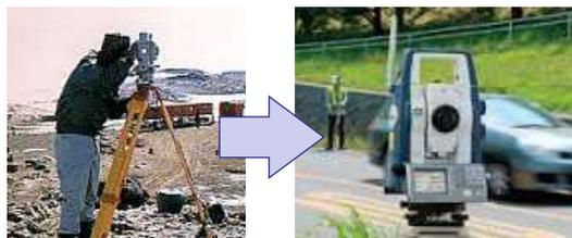
距離や角度を計測する測量機器(トータルステーション等)が高度化し、計測精度が大幅に向上するとともに、より長距離の計測が可能になった。
