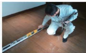
建物に歪みがある可能性が確認された場合は水平器で傾きを確認。
