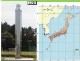
電子基準点と国内の設置箇所
