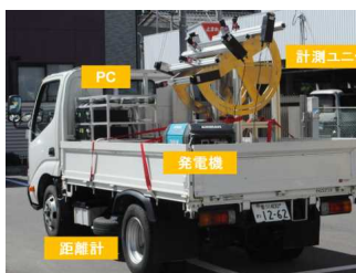
3次元形状計測カメラ 6台
