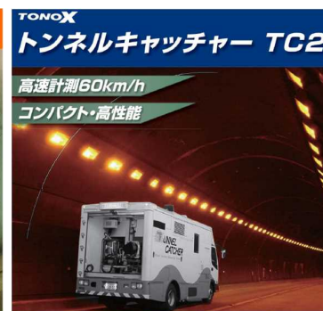
トンネル覆工表面調査 (レーザー計測)
