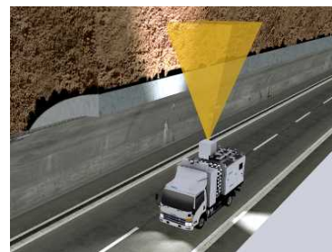
高速走行非接触レーザーイメージ
