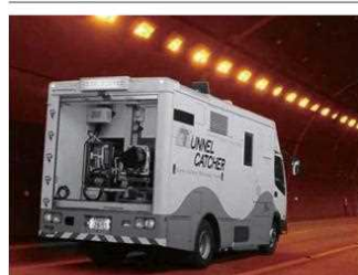
レーザー計測車 (TC2)
