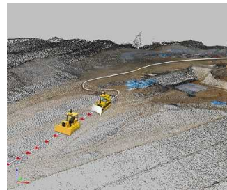
重機の搬入経路策定
