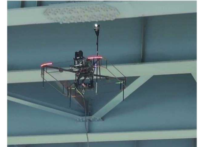
現場検証に使用する飛行ロボット
