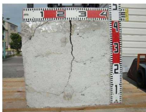
操作端末画面に表示されたクラックスケールおよび計測目盛
