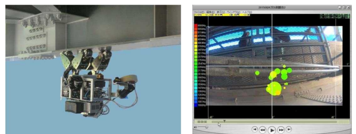
名古屋大実験施設 (N2U-BRIDGE) での走行実験と指向性音カメラによる計測結果
