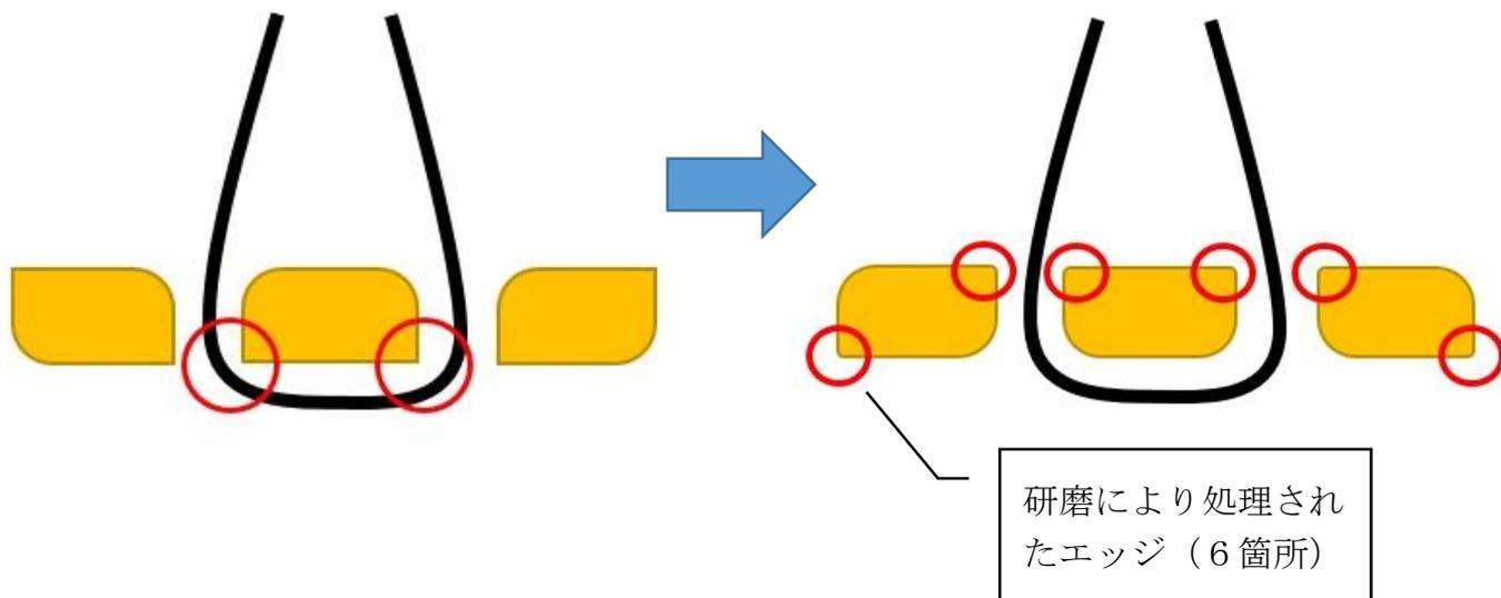
金属製プレートに研磨行程を追加しエッジを処理し、
