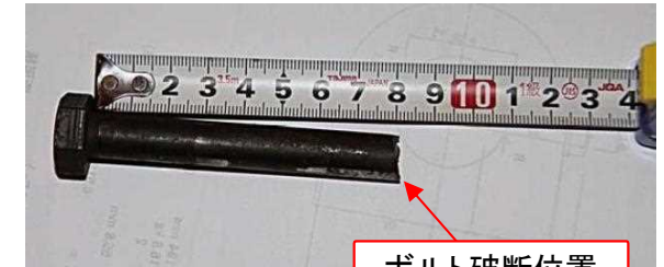
ボルト破断位置
