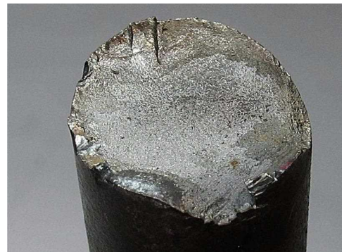
写真3. ボルト破断面
