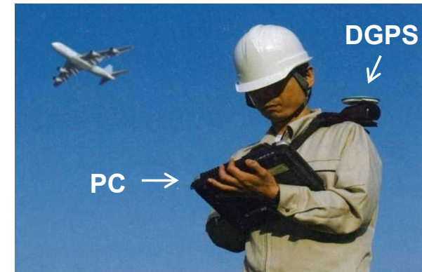
空港舗装巡回等点検システム
