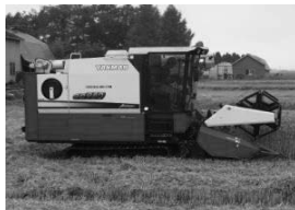
水稲、麦、大豆を収穫できる 大型汎用コンバイン
