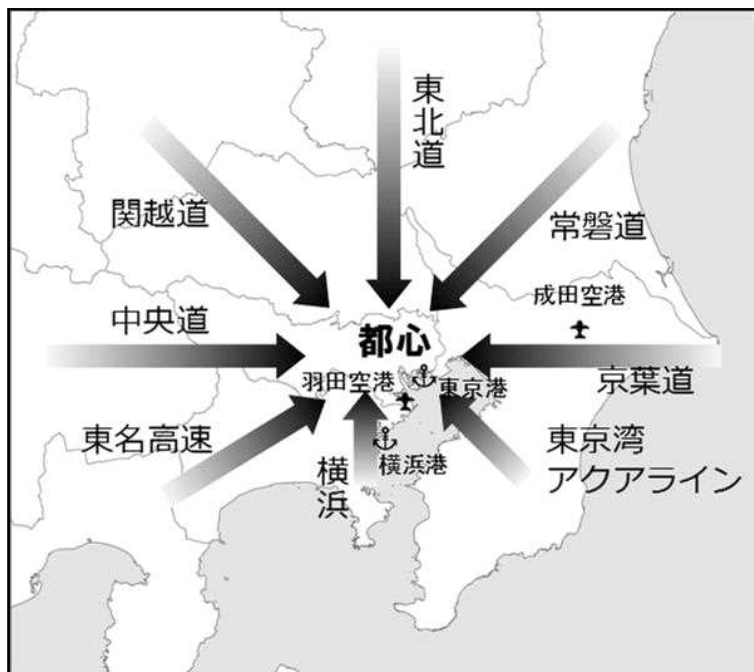
<八方向作戦による道路啓開>
