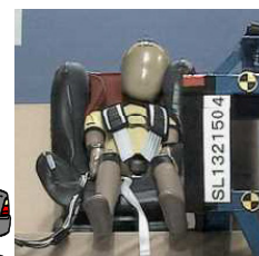
チャイルドシートの側面衝突試験
