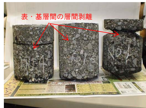
層間剥離した箇所のコア抜き取り
