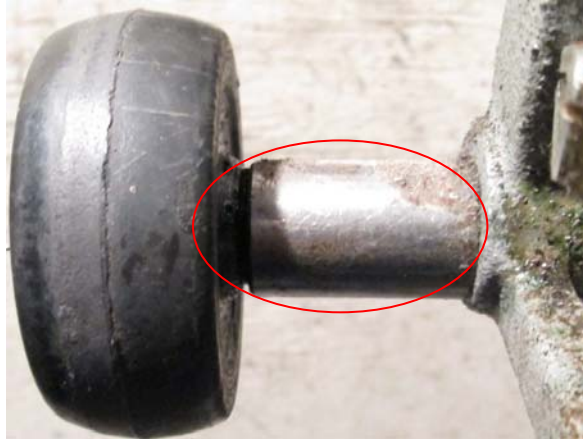
写真 I - 6 可動ロック装置のローラー軸の傷
