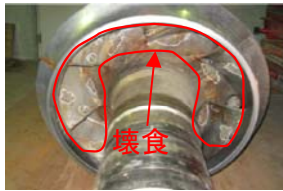
ポンプ羽根車の壊食
