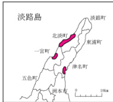
図 7.1 兵庫県南部地震の際の現地調査による震度 7 の分布 5) (洲本市小路谷は震度 6)
