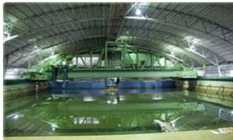
海洋構造物試験水槽
