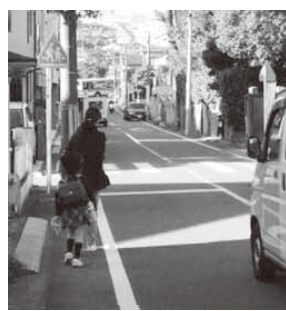
<歩行の支障となる電柱>
