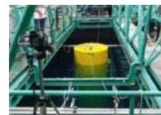
世界最大の風車マスト模型による水槽実験
