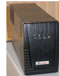
■ 無停電電源装置 電源が切断された場合も、一定時間、接続されている機器に対して、停電することなく電力を供給し続ける電源装置
