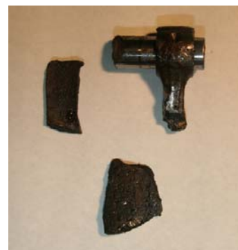
図6 折れたコンロッド小端部 及びシリンダブロック破片
