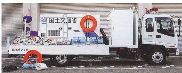
派遣する排水ポンプ車(イメージ)
