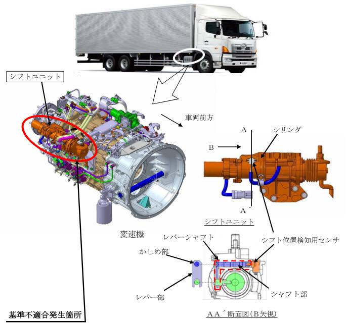
12段式自動変速機搭載車において、変速を行う装置(シフトユニット)のシリンダの一加工が不適切なため、シフト位置検知用センサと連動するレバーシャフト部に異物が入り、さらに、レバーシャフトのシャフト部へのグリス塗布が不足していたため、レバーシャフトが摺動不良となり、レバーシャフトのレバー部とシャフト部を結合しているかしめ部が緩む場合がある。そのため、当該センサが正常なシフト位置を検知できず変速不能となり、最悪の場合、走行不能となるおそれがある。
