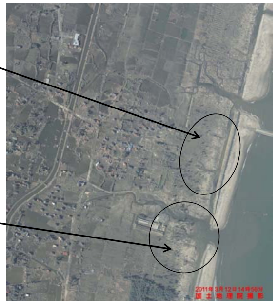
堤防の陸側に大きな洗掘溝。松林の一部は残存
