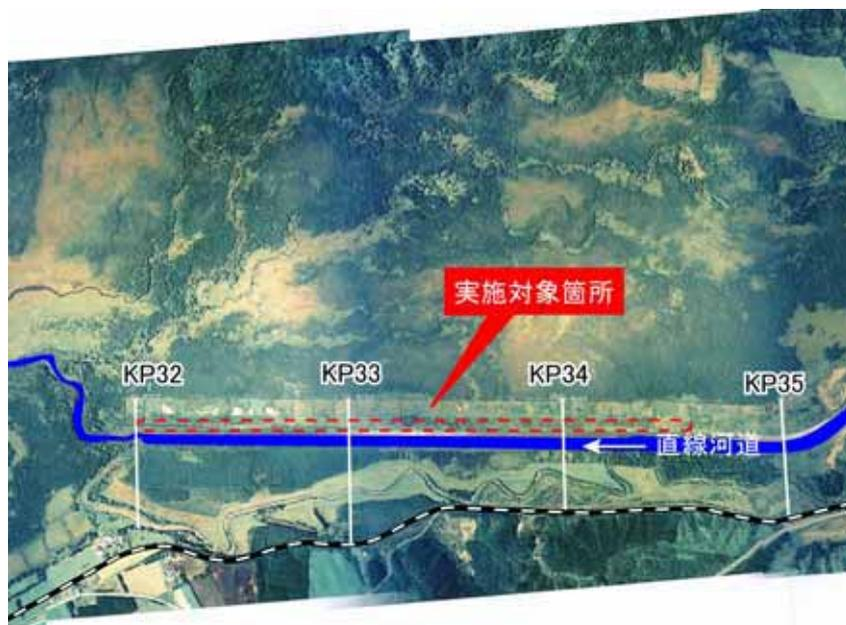
図 4-7 右岸残土の撤去区間
