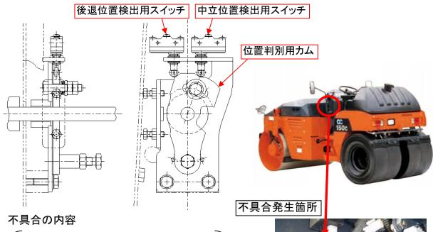
変速機の操作レバーにおいて、中立位置検出 用スイッチ及び後退位置検出用スイッチの取付 位置が不適切なため、位置判別用カムから過度 な水平力がかかり、当該スイッチが損傷する場 合がある。そのため、原動機が始動しない、もし くは操作レバーを後退位置に操作しても後退灯 が点灯しないおそれがある。
