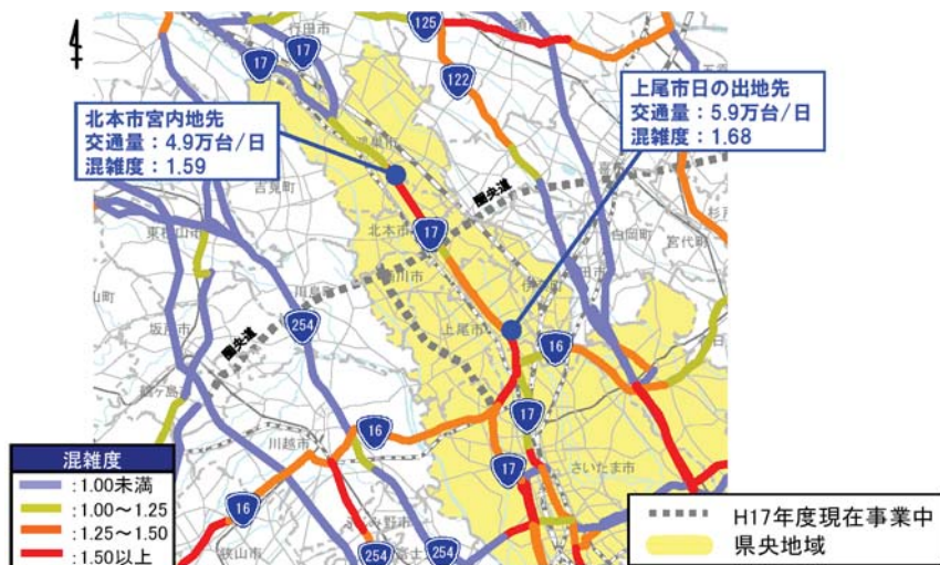
図1 並行する国道17号の混雑状況(現況)
