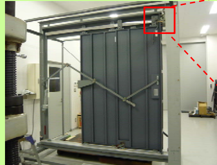
乗り場戸の施錠装置の構造 (写真は再現機のもの)
