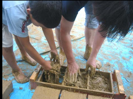
泥を踏んでこねる 型枠の中へ入れて 煉瓦を抜き取る
