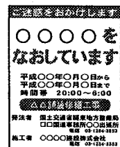
【統一的な工事看板(イメージ)】
