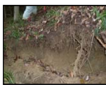
① 滑落斜面側部のクラック(h=1.2m)
