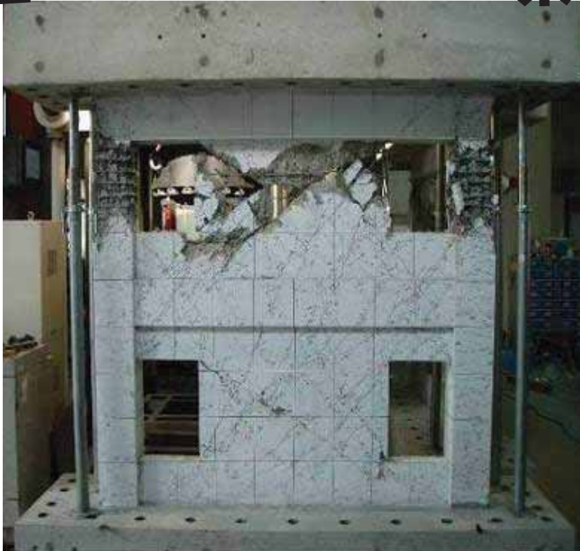
2層側柱がせん断破壊
