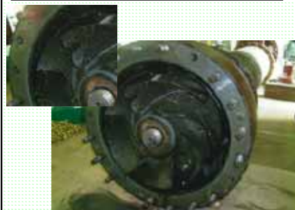
ポンプの構成部分の一部(羽根車)を取替え、利用可能な部分を引き続き使用
