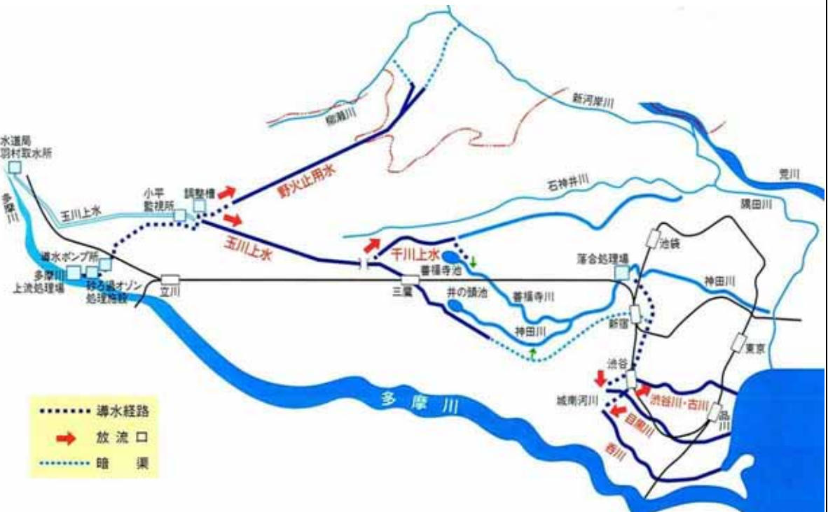
下水処理水を導水路により水路へ放流
