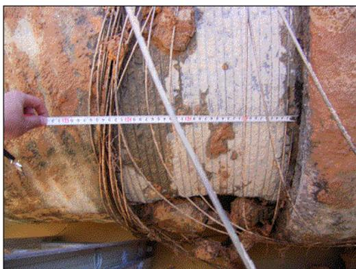
P C鋼線が発錆・破断し、管体が破裂
