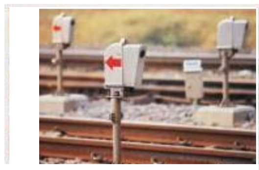
踏切障害物検知装置
